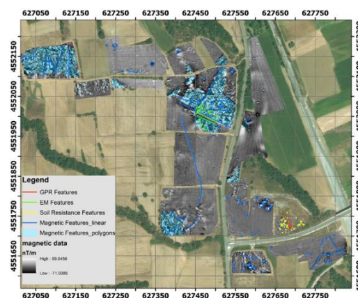
Εικόνα 19. Διαγραμματική ερμηνεία των αποτελεσμάτων των γεωφυσικών διασκοπήσεων στην Ειδομένη. Υπέρθεση στον χάρτη των αποτελεσμάτων των μαγνητικών διασκοπήσεων.
