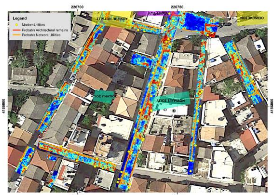
Εικόνα 9. Ερμηνεία γεωφυσικών αποτελεσμάτων. Μωσαϊκό οριζόντιων τομών του γεωραντάρ από το Νότιο τμήμα της περιοχής ενδιαφέροντος.
