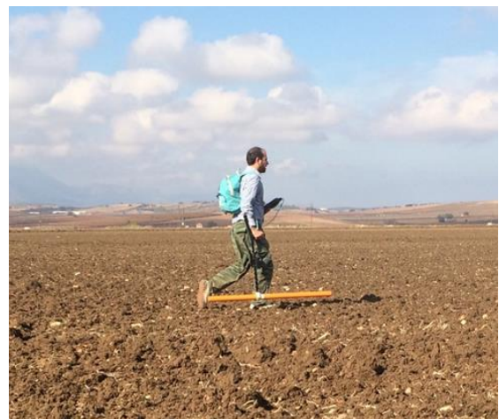
Εικόνα 5. Το όργανο CMD MiniExplorer που χρησιμοποιήθηκε κατά τις ηλεκτρομαγνητικές διασκοπήσεις.
